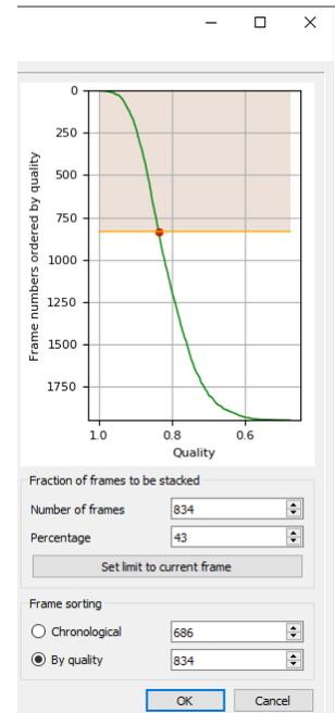
Im nächsten Schritt entscheidet der Benutzer, wie viele Bilder zum Stacken verwendet werden. Die GUI öffnet eine Ansicht auf die Szene, in der die Frames entweder nach abnehmender Gesamtqualität oder chronologisch geordnet angezeigt werden. Mit einem horizontalen Schieberegler kann der Benutzer durch alle Bilder scrollen. Alternativ kann er „Play“ / „Stop“ drücken, um die Bilder als Video anzuzeigen.
