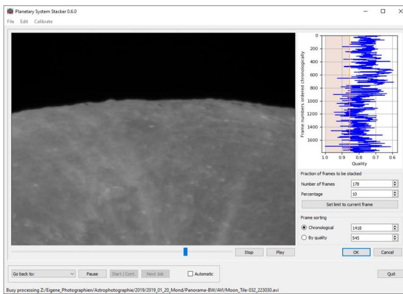
Alternativ dazu kann durch Drücken der Taste „Set limit to current frame“ die Grenze des schattierten Bereichs an die Position des gerade angezeigten Bildes verschoben werden. Das Ergebnis ist im Ausschnitt auf der rechten Seite zu sehen.
