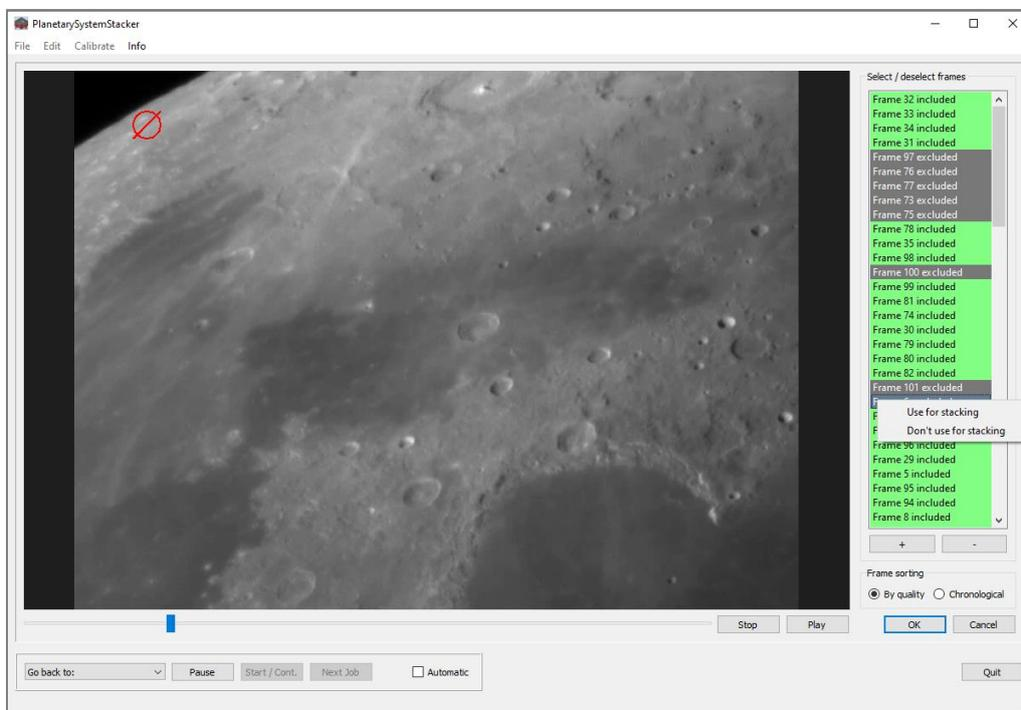
In einigen Videos gibt es beschädigte Bilder, die Probleme im Stacking-Workflow verursachen. Häufig weisen sie sogar scharfe Artefakte auf, die der Bild-Ranking-Algorithmus fälschlicherweise als Zeichen einer sehr hohen Qualität interpretiert. Es ist daher wichtig, fehlerhafte Bilder frühzeitig im Verarbeitungs-Workflow auszuschließen. Da dies für PSS nur sehr schwer automatisch zu bewerkstelligen ist,
