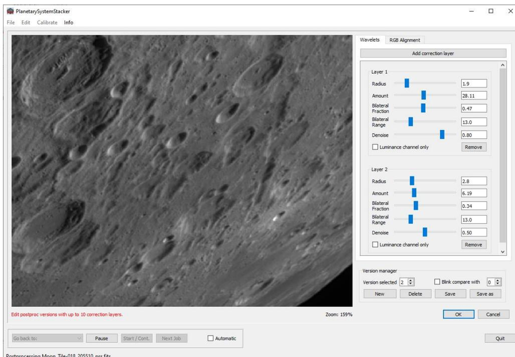
Wenn der Benutzer den Versionsmanager-Button „New“ drückt, wird eine neue Version mit den gleichen Parametereinstellungen wie die aktuell gewählte Version an die Versionsliste angehängt, und der Versionswähler schaltet auf die neue Version um. Auf diese Weise ist es einfach, Varianten bestehender Versionen zu erstellen und sie mit der Version zu vergleichen, von der sie abgeleitet wurden.
