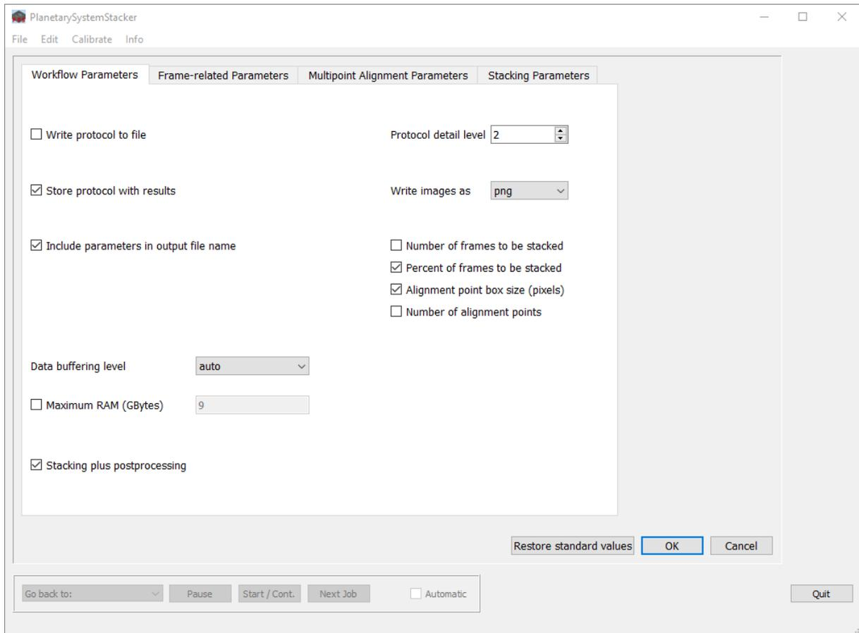
Beim Verlassen des Parameterdialogs und beim Beenden des Programms schreibt PSS die Konfigurationsdatei „PlanetarySystemStacker.ini“ in das Home-Verzeichnis des Benutzers. Bei späteren Programmläufen werden die Parameter automatisch aus dieser Datei geladen, der Eingabedialog öffnet sich nicht, und PSS ist bereit für die Jobeingabe. Parameter können weiterhin über das Menü „Edit / Edit configuration“ geändert werden.
