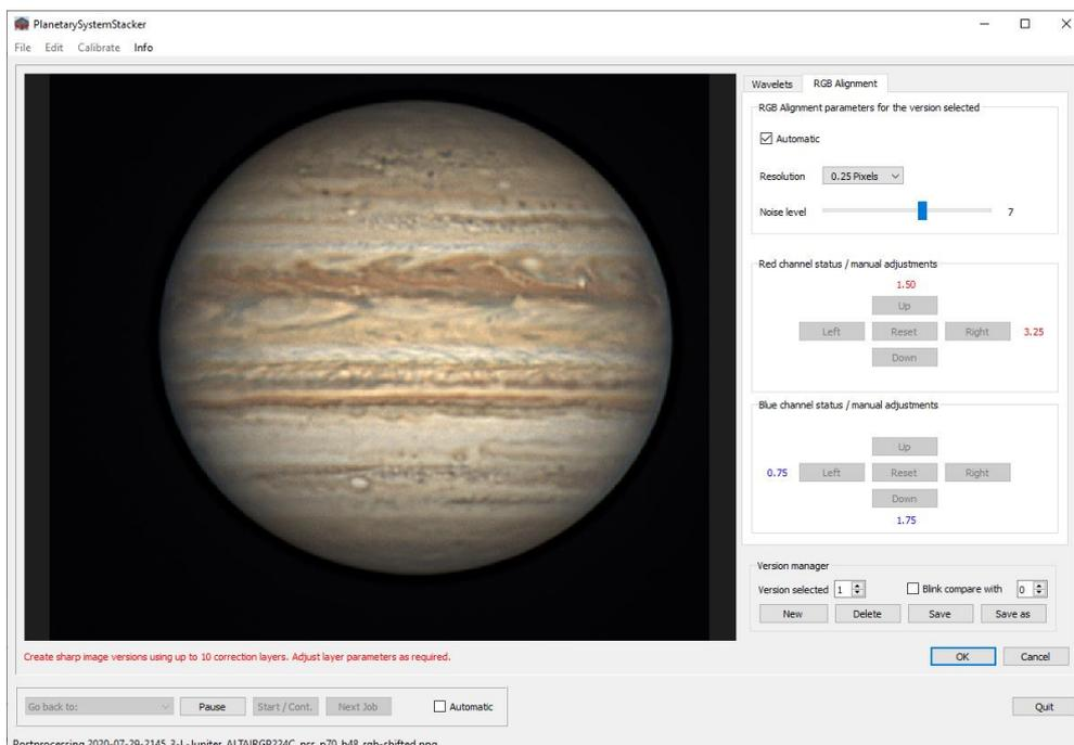
Die roten und blauen Zahlen in den „Channel status“-Feldern zeigen die automatisch eingestellten Kanalverschiebungen in Pixeln an. Im Bildbetrachter links kann das Ergebnis begutachtet werden.
